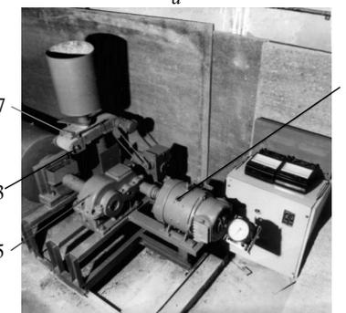
Рис. 1. Экспериментальная установка шаровой мельницы Привод шаровой мельницы 0,5х1,95м
