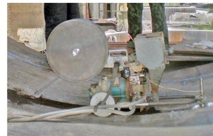
Рис. 9. Сварка реконструированного бандажа с корпусом ТБ (операция 030)
