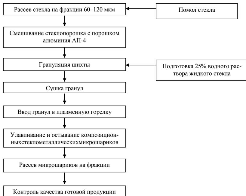
Рис. 1. Технологическая схема получения композиционных стеклометаллических микрошариков
