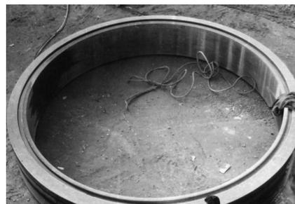
Рис. 6. Бандаж типа «П» реконструированный в тип «В» (операция 020)
